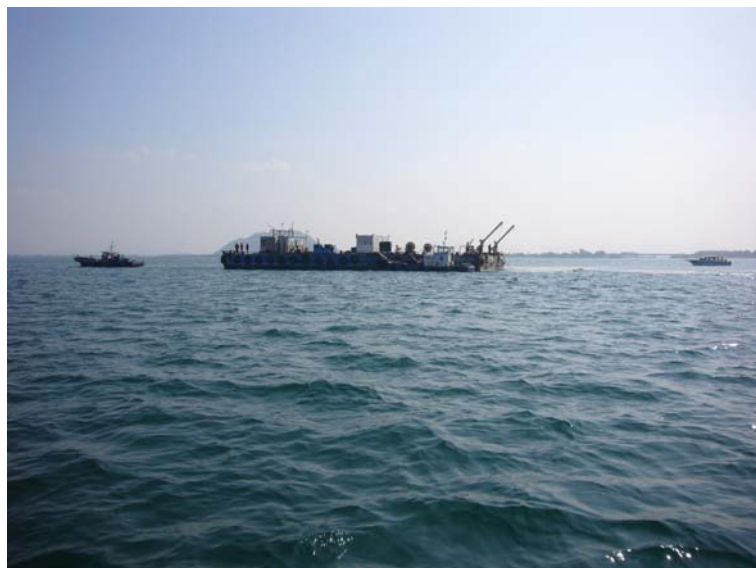
図 17 反射法エアガン発震作業[1] 滋賀県近江八幡市沖島を望む。標準発震点間隔は 50m である。
