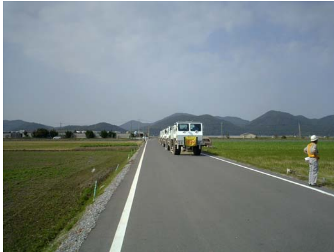
図 13 バイブレータ発震作業状況[2] VP. 4359 近江盆地大中土地改良区農道。この区間では、一般車両の進入規制があり、舗装強度あるいは埋設管の存在確認等の十分な事前準備が必要であった。
