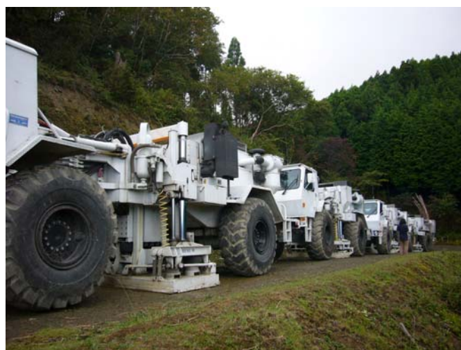
図 12 バイブレータ発震作業状況[1] VP. 1475 京都市右京区京北芹生町地区の灰屋川沿い村山林道。この地点において平成 18 年 10 月 6 日にバイブレータ発震現地見学会を実施。
